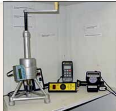
На переднем плане – прибор для определения прочности бетона методом отрыва со скалыванием.
