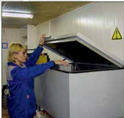
Пропарочная камера для ускорения определения прочности бетона на сжатие.
